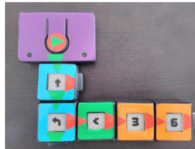
Figura 2 – Blocos de programação tangível do robô MI-GO
